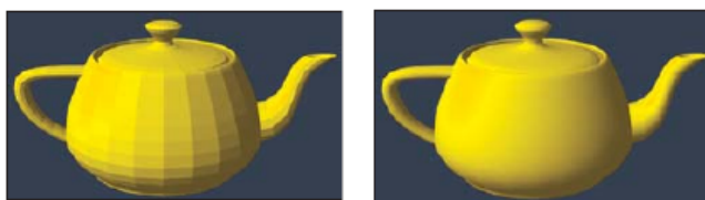
Slika 8.23: Ilustracija ravanskog i interpoliranog senčenja na modelu čajnika.
