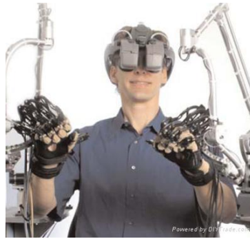
Slika 1.15: Radna stanica zasnovana na povratnoj sprezi koja predstavlja integrisani sistem simulacija pokreta kompletne šake leve i desne ruke (preuzeto sa: http://www.diytrade.com/china/pd/5554912/Immersion_Haptic_Force_Feedback_Workstation.html ).
