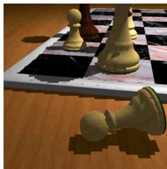
Slika 8.34: Efekat nazubljenosti dobijen naivnim preslikavanjem senki (preuzeto sa http://www-sop.inria.fr/rees/Marc.Stamminger/psm/ ).
