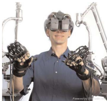
Slika 1.14: Radna stanica zasnovana na povratnoj sprezi koja predstavlja integrisani sistem simulacija pokreta kompletne šake leve i desne ruke (preuzeto sa: http://www.diytrade.com/china/pd/5554912/Immersion_Haptic_Force_Feedback_Workstation.html ).
