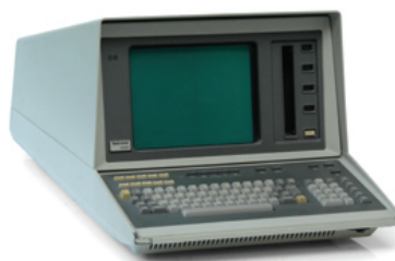
Slika 1.18: Tektronix računar sa DVST monitorom (1970-e).
