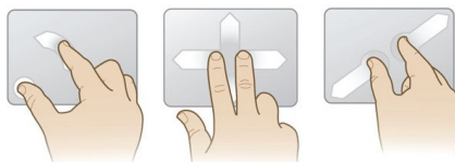
Slika 1.13: Multi-touch – funkcionalnost pomoću koje ekrani osetljivi na dodir registruju istovremeni višestruki dodir po površini (preuzeto sa: https://www.engadget.com/2010/04/20/synaptics-extends-multitouch-gesture-suite-to-linux-chrome-os-i/ ).
