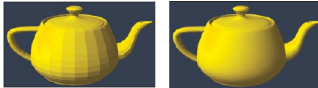
Slika 8.23: Ilustracija ravanskog i interpoliranog senčenja na modelu čajnika.
