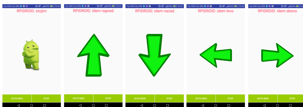
Слика 5.2: Кориснички интерфејс активности за навођење робота
