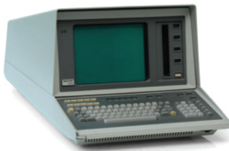
Tektronix računar sa DVST monitorom (1970-e)
