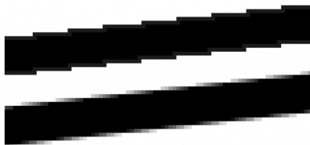
Primer duži bez korišćenja antialiasing tehnika (gore) i sa korišćenjem antialiasing tehnika (dole)
