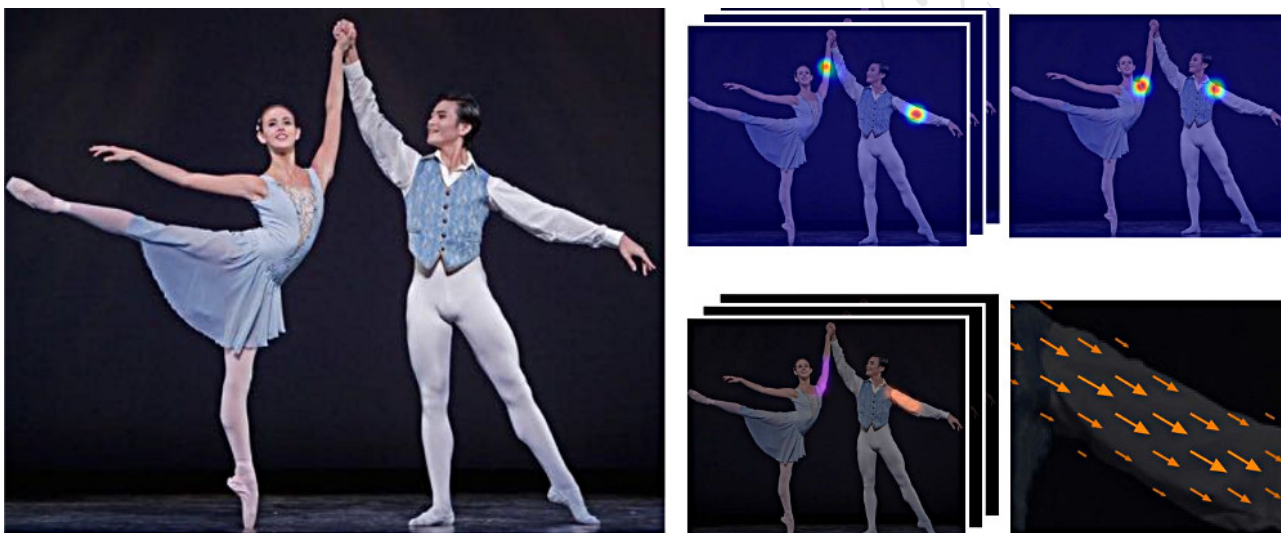
Slika 11.20: Primer ulazne slike (levo), mapa pouzdanosti za dve vrste zglobova (gore desno) i vektorskog polja koje definiše orijentaciju dela tela koji ih povezuje (dole desno).
