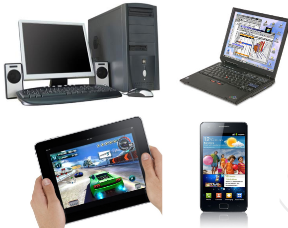
Slika 1.8: Stoni računar. Prenosni računar: IBM ThinkPad. Tablet: Apple Ipad 2. Pametni telefon: Samsung Galaxy S2.
