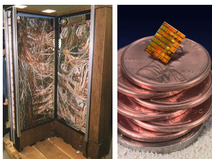
Slika 1.5: Integrisana kola dovela su do minijaturizacije i kompleksni žičani spojevi su mogli biti realizovani na izuzetno maloj površini.
